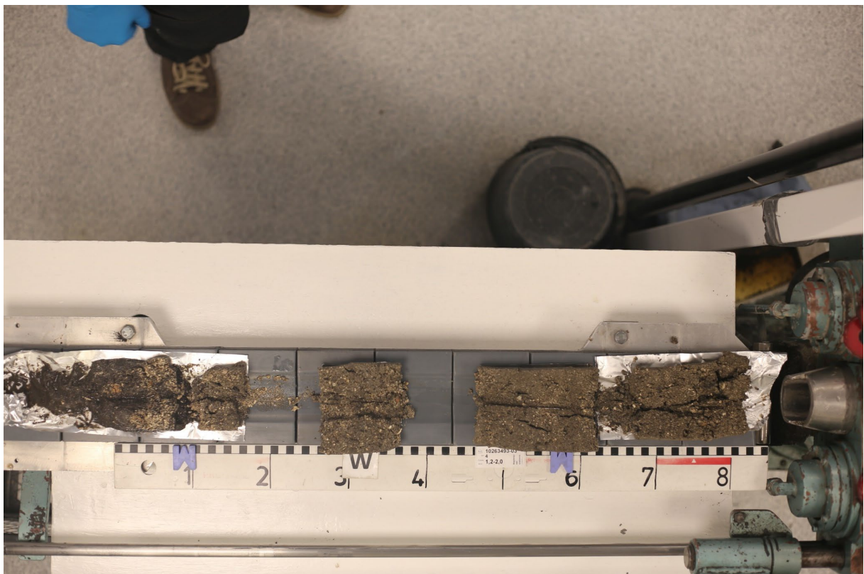
Bilde 4-2: Prøvesylinder BP 4. Intervall 1,2-2,0 meter: Sand, siltig og organisk
